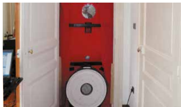
Le test d'étanchéité à l'air (ou test de la «porte soufflante») sert à mesurer les entrées et sorties d'air parasites.
